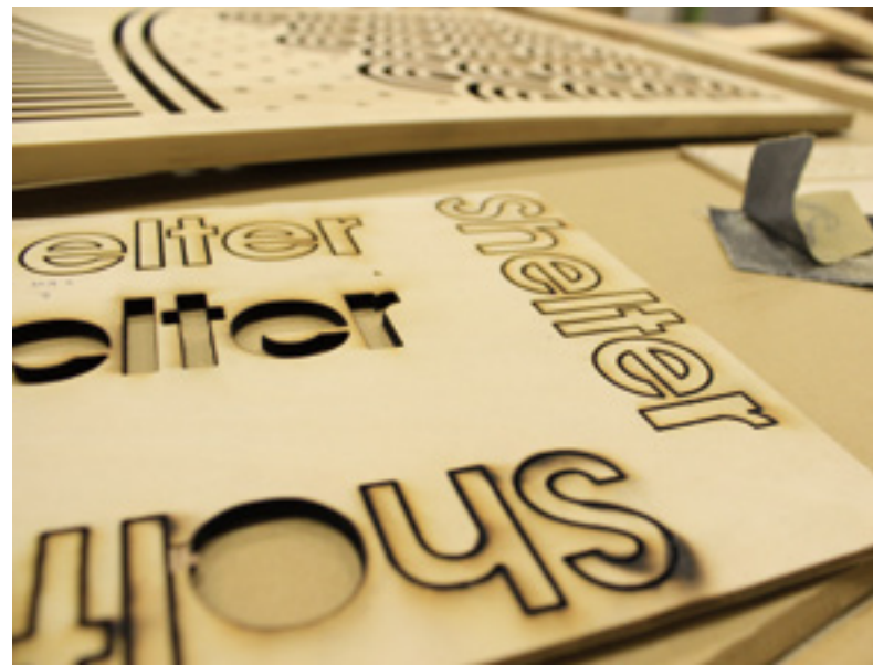
レーザーカッターを使用する事で青海波のような細かい模様も美しく切り出すことが出来ました。 レーザーカットされた木板を丁寧に磨いて仕上げます。
